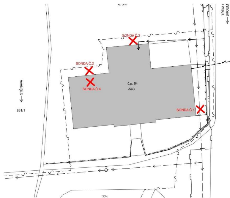
Obrázek 3.1: Poloha kopaných sond u objektu parc. č. st. 543 (Soukenická č.p. 64).
